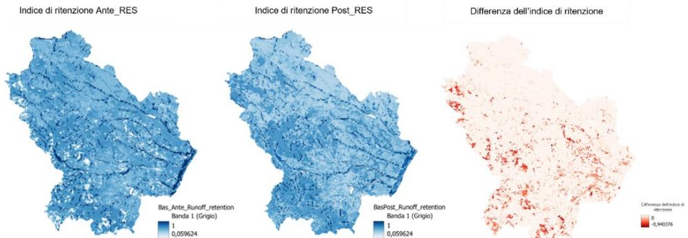
**Figura 200.** A sinistra le mappe dell'indice di ritenzione del deflusso superficiale. Visualizzazione comparativa delle condizioni pre-RES (sinistra) e post-RES (destra) mediante scale cromatiche identiche. Lo schiarimento delle tonalità in prossimità dei cluster RES indica una ridotta capacità di ritenzione idrica. A destra la mappa delle differenze dell'indice di Ritenzione del Deflusso
